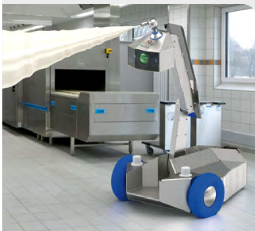
Mit seinem ausfahrbaren Arm erreicht der Roboter auch höher gelegene Bereiche problemlos. © Fraunhofer IVV
