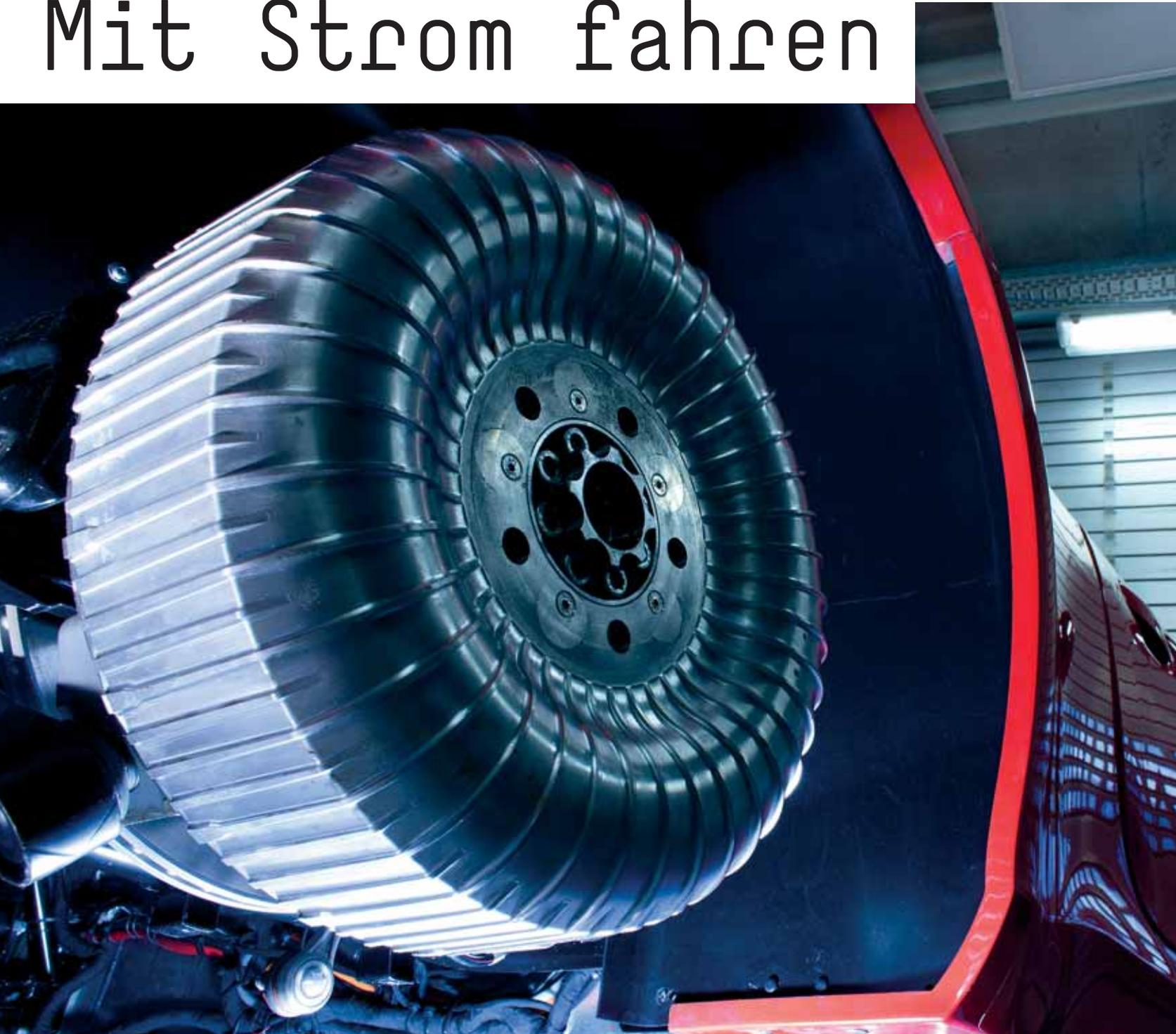
Radnabenmotoren bieten die Möglichkeit, Kosten und Energieverbrauch von Elektrofahrzeugen durch den Wegfall von Komponenten des klassischen, mechanischen Antriebsstrangs zu senken.
