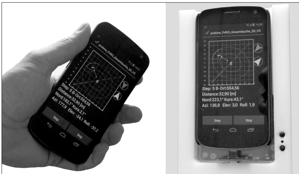
Mit zusätzlicher Hardware und der LawinenFon-App wird jedes Smartphone zum Lawinensuchgerät. Im Bild: der Prototyp des Galileo-LawinenFons. (© Fraunhofer IML) | Bild in Farbe und Druckqualität: www.fraunhofer.de/presse
